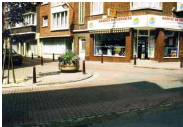
Paaltjes en bloembakken verhinderen het parkeren op het voetpad aan dit kruispunt. De onderlinge zichtbaarheid tussen de autobestuurders en de fietsers in de tegenrichting, essentieel voor de veiligheid, blijft op deze manier optimaal.
